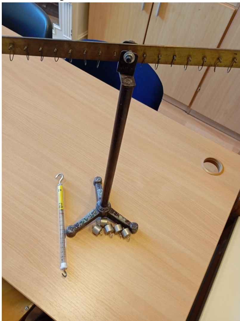
Karos mérleg, azonos tömegű testekből álló súlysorozat, rugós erőmérő
