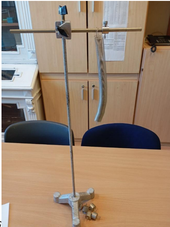
Rugó állványon, azonos tömegű testekből álló súlysorozat
