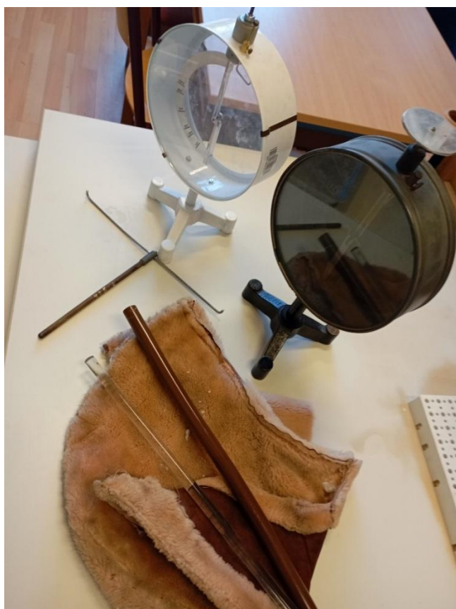
Két darab elektroszkóp, fém összekötő vezető, PVC rúd, üvegrúd, szőrme, bőr
