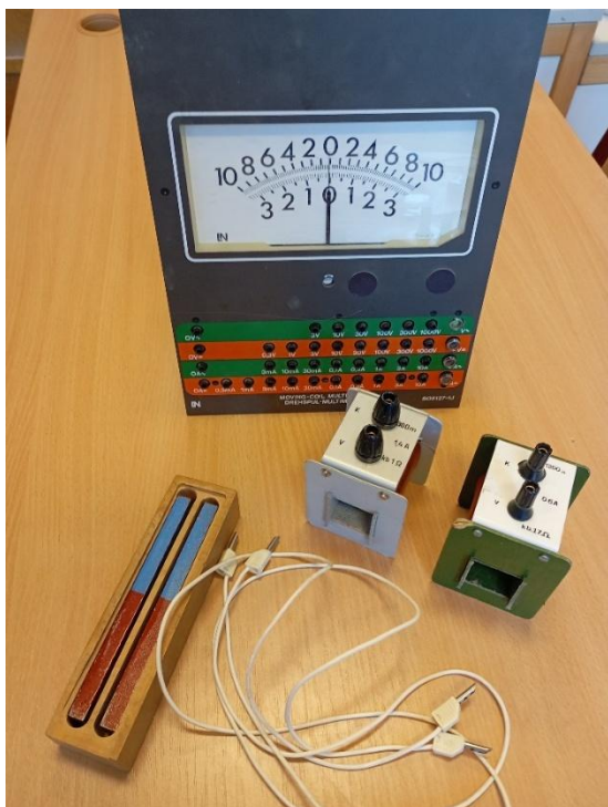
Középállású multiméter, rúd­mágne­sek, két eltérő menetszámú tekercs, vezeték
