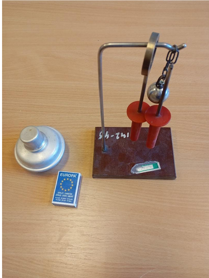
Szilárd anyagok hőtágulását bemutató eszköz, borszeszegő, gyufa
